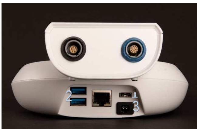
Рисунок 4: Разъемы на устройстве QSCREEN (вверху), разъемы на базовой станции (внизу)
