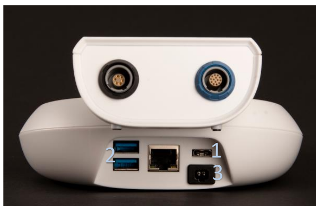
Figura 4: Tomadas do dispositivo QSCREEN (em cima), tomadas da estação de acoplamento (em baixo)
