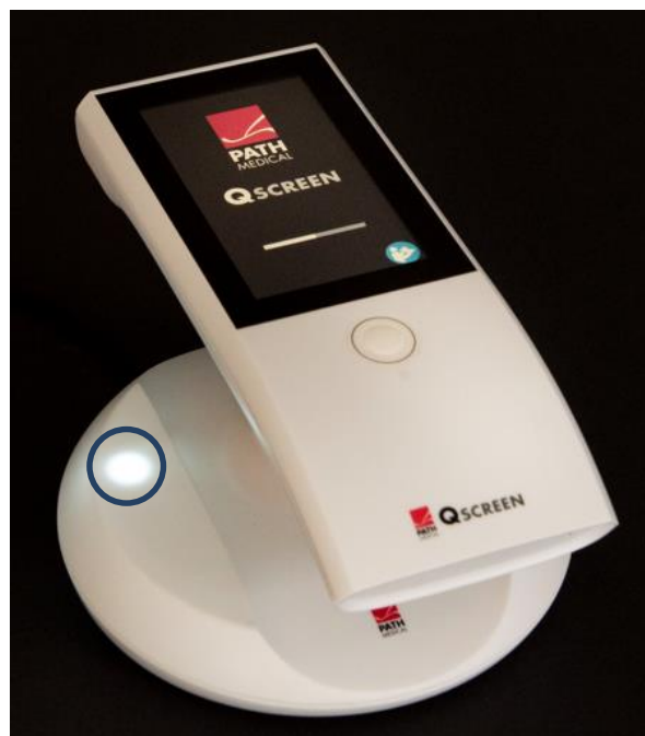
Figura 5: spia di segnalazione della docking station in fase di caricamento
