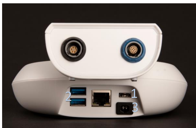
Figura 4: Conectores del equipo QSCREEN parte superior), conectores de la base de conexión (parte inferior)
