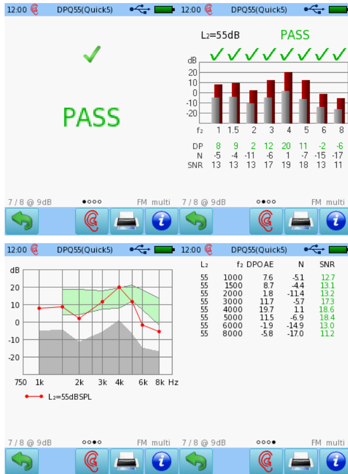
DPOAE Quick 结果（上部左图：整体结果；上部右图：每个被测试 f_2 的 DPOAE 和噪声级柱状条；下部左图：DPOAE 图表；下部右图：数据表）
