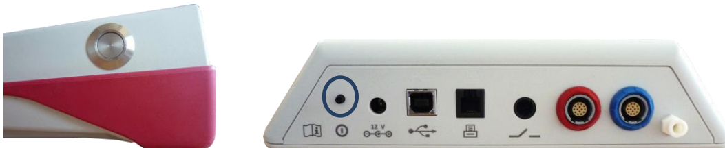
Мал. 2: Кнопка вмикання в портативному пристрої (лівий малюнок) та настільному пристрої (правий малюнок, позначено синім колом)
