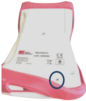
Мал. 3: Кнопка перезавантаження портативного пристрою
