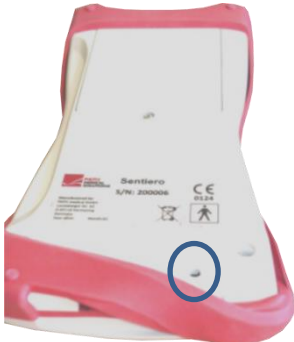
Şekil 3: El cihazları için cihaz resetleme butonu
