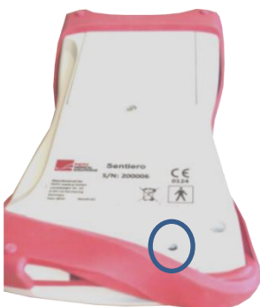
Figur 3: Återställningsknapp för handhållna enheter
