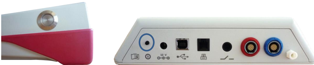
Figur 2: Strömbrytare för handhållen enhet (vänster) och bordsplacerad enhet (höger, markerad med en blå ring)
