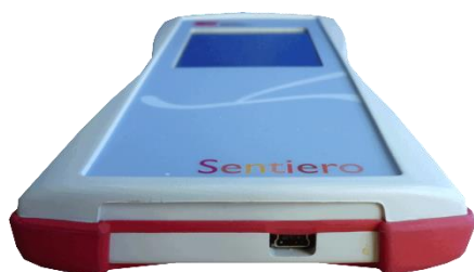
Figur 5: USB kontakt på handhållen enhet
