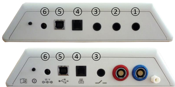
Obrázok 6: Panel konektorov stolnych pristrojov (obrazok: Senti Desktop, dole: Sentiero Desktop)
