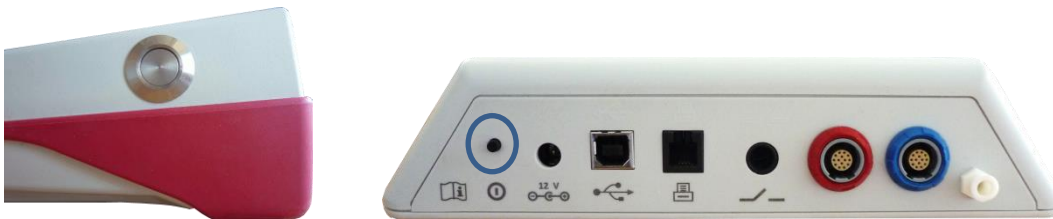
Obrázok 2: Prenosný (ľavý) a prepínač na pracovnej ploche (pravý modrý kruh)
