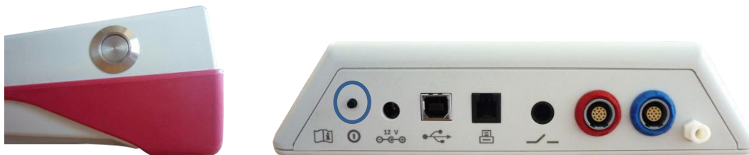
Figura 2: Botão liga/desliga para dispositivo portátil (esquerda) e de mesa (direita, marcado com o círculo azul)
