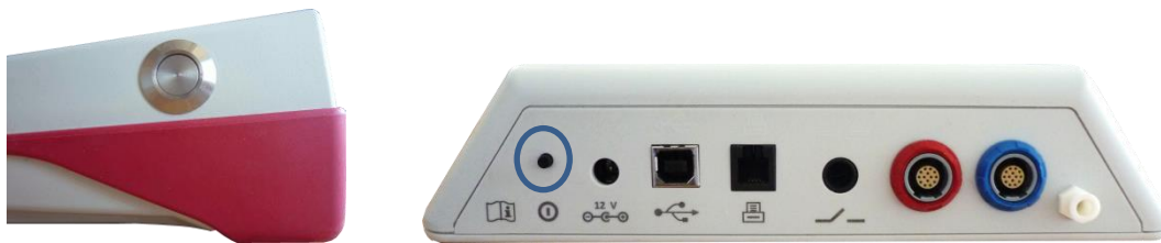
Rys 2: Włącznik urządzenia przenośnego (po lewej) i stacjonarnego (po prawej)
