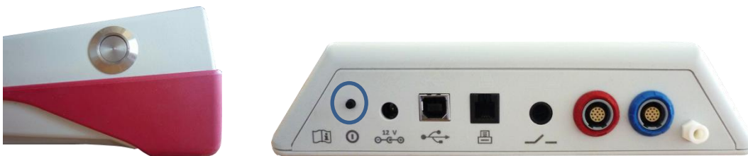
ფიგურა 2: On / off switch ხელის (მარცხნივ) და desktop მოწყობილობა (მარჯვენა, აღნიშნულია ლურჯი წრე)
