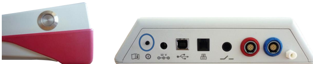
Figura 2: L'interruttore on/off per handheld (sinistro) e il dispositivo desktop (destra, segnato con cerchio blu)
