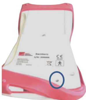
Figura 3: Pulsante di ripristino del dispositivo per dispositivo handheld
