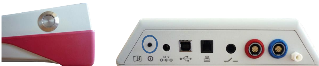
Figura 2: Interruptor de encendido/apagado para equipos portátiles (izquierda) y de escritorio (derecha, marcado con un círculo azul)
