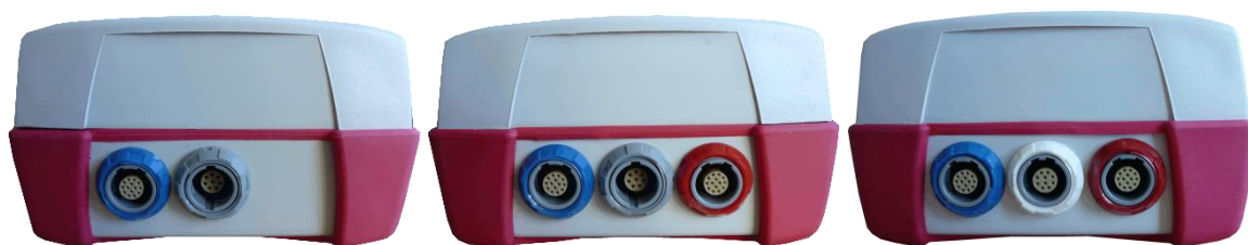
Obrázek 4: Panel konektorů přenosných přístrojů (zleva: Senti, Sentiero, Sentiero Advanced)
