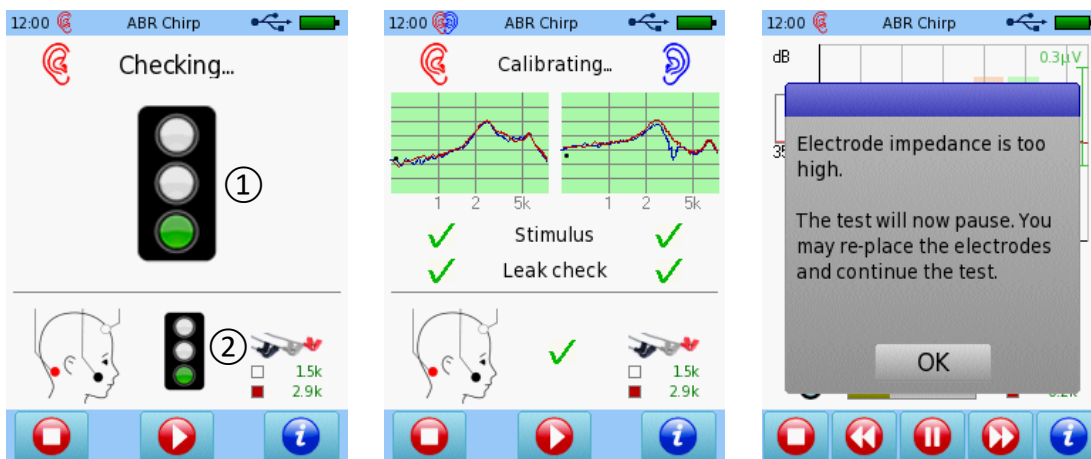
Рисунок 50: Измерение импеданса ABR и калибровка ушного зонда (слева: нормальные значения импеданса и подгонка ушного зонда (режим simple); в центре: нормальные значения импеданса и подгонка ушного зонда (бинауральный тест, режим expert; справа: неудовлетворительный / не корректный импеданс во время измерения)
