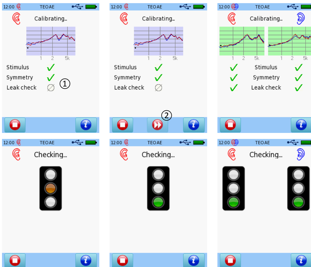
Figura 30: Calibrarea sondei de ureche TEOAE (stânga sus: modul expert monaural; mijloc sus: modul expert monaural cu opțiunea de salt; dreapta sus: modul expert binaural; stânga/mijloc jos: modul simplu monaural; dreapta jos: modul simplu binaural)
