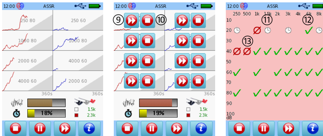
Figura 60: Măsurare ASSR (sus: măsurare monoaurală ASSR de 40 Hz; stânga sus: ecran de măsurare standard; dreapta sus: ecran de măsurare cu grafic de zgomot EEG; jos: măsurare binară ASSR de 80 Hz; stânga jos: ecran de măsurare standard; dreapta: starea de măsurare și matricea rezultatelor)
