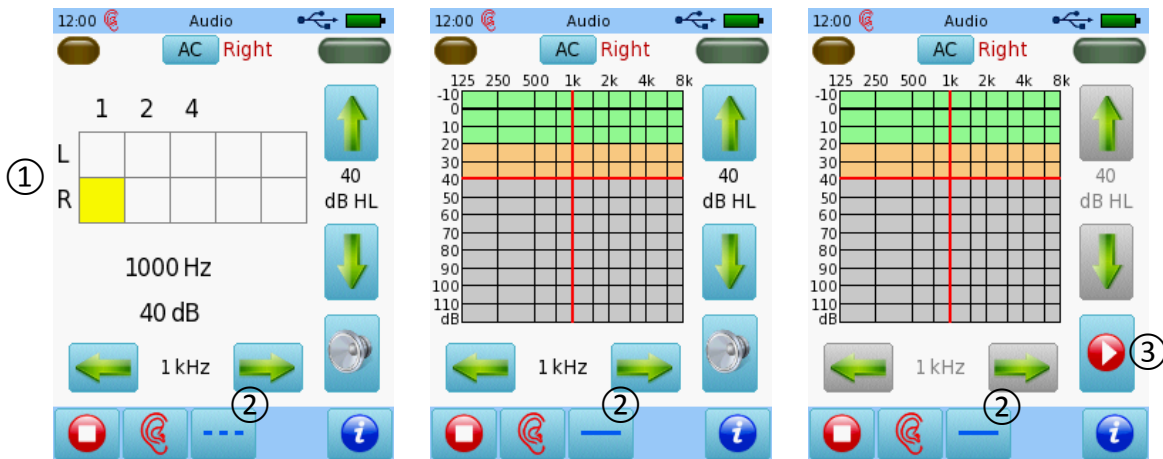
Figura 3: Interfețele cu utilizatorul Audio pentru diferite protocoale (stânga: Ecran, mijloc: Diagnosticare, dreapta: Audio Auto)
