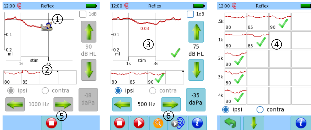
Figura 74: Măsurarea automată a reflexului acustic (stânga: determinarea pragului cu modul animație activat; mijloc: modul manual după terminarea testului; dreapta: prezentarea generală a rezultatelor)
