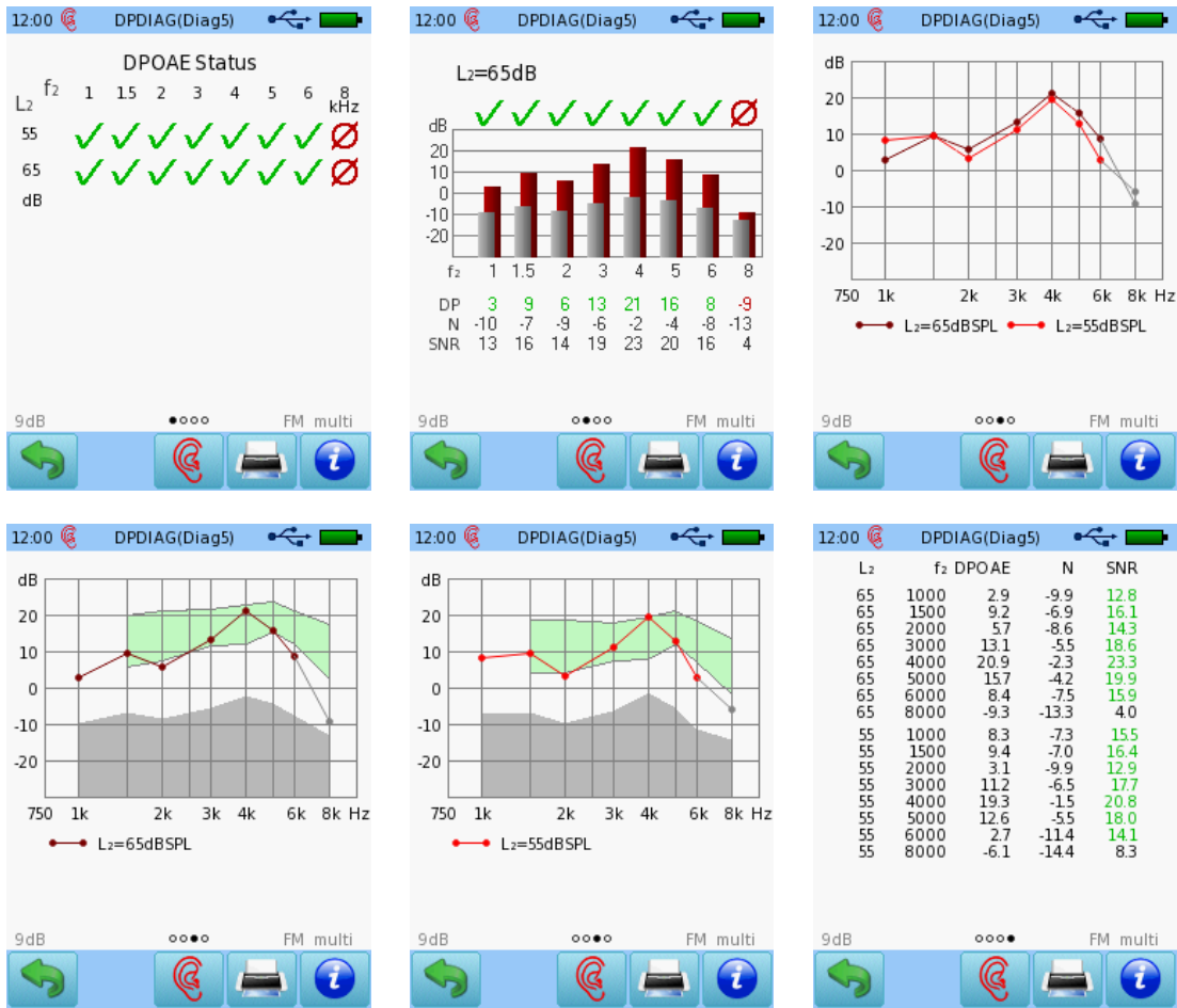
Figure 41: Résultat OEAPD Diagnostic (en haut à gauche : Matrice de validité des OEAPD ; en haut au milieu : OEAPD et les barres de niveau de bruit de fond pour chaque f_2 testé ; en haut à droite, en bas à gauche, en bas au milieu : OEAPDgramme ; en bas à droite : tableau de données)
