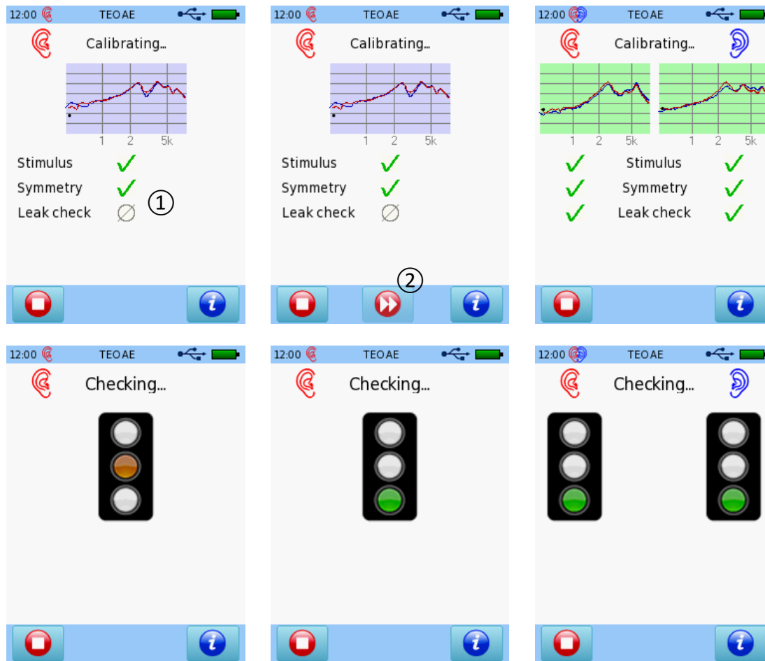
Figure 32: Calibrage de la sonde auriculaire OEAET (en haut à gauche : mode expert monaural ; en haut au milieu : mode expert monaural avec étalonnage facultatif ; en haut à droite : mode expert binaural ; en bas à gauche/au milieu : mode simple monaural ; en bas à droite : mode simple binaural)
