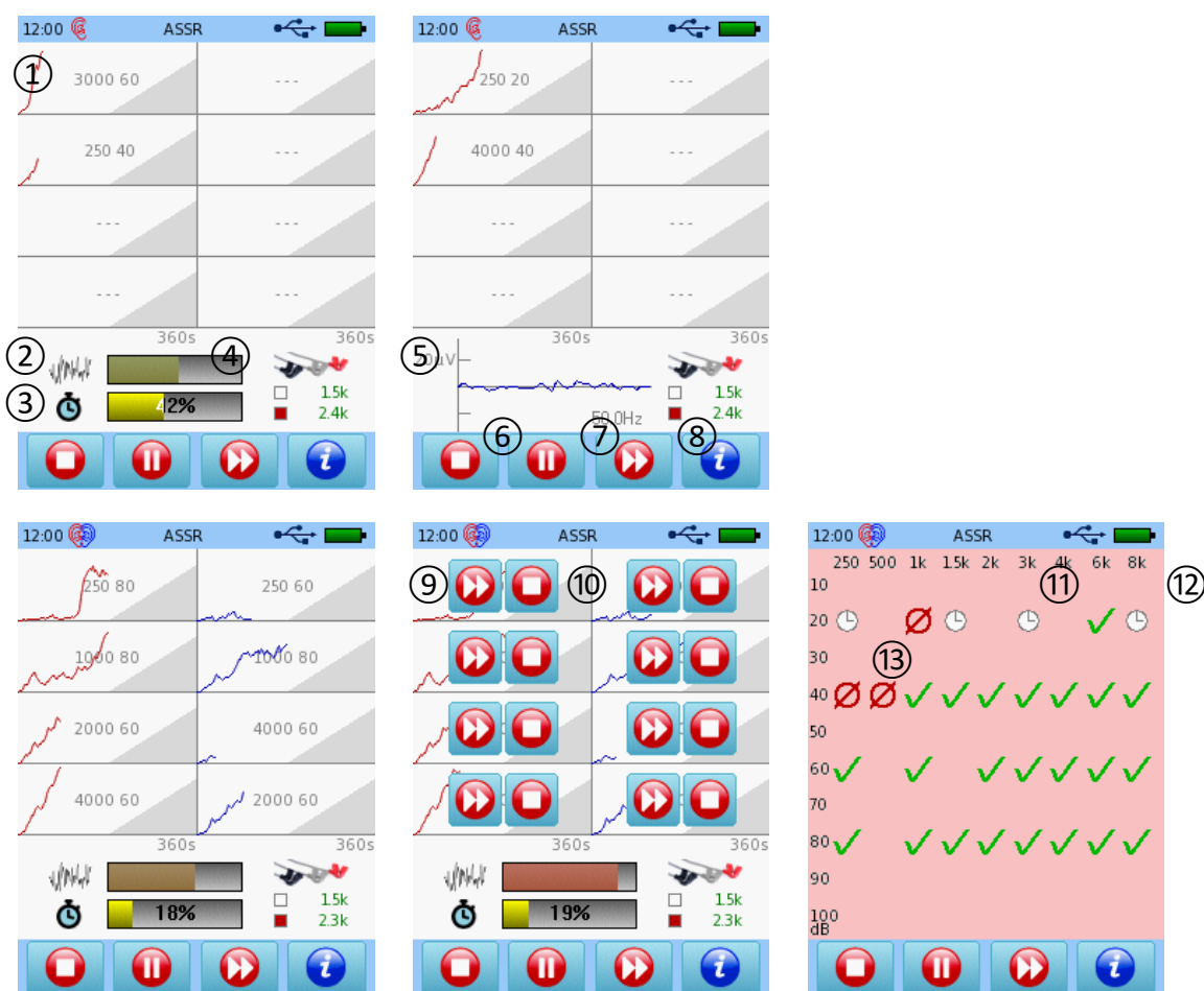
Figure 62: Mesure ASSR (en haut : mesure ASSR monaurale 40 Hz ; en haut à gauche : écran de mesure standard ; en haut à droite : écran de mesure avec graphique du bruit EEG ; en bas : mesure ASSR binaurale 80 Hz ; en bas à gauche : écran de mesure standard ; en bas au milieu : sélection sauter/arrêter ; en bas à droite : état de la mesure et matrice des résultats)
