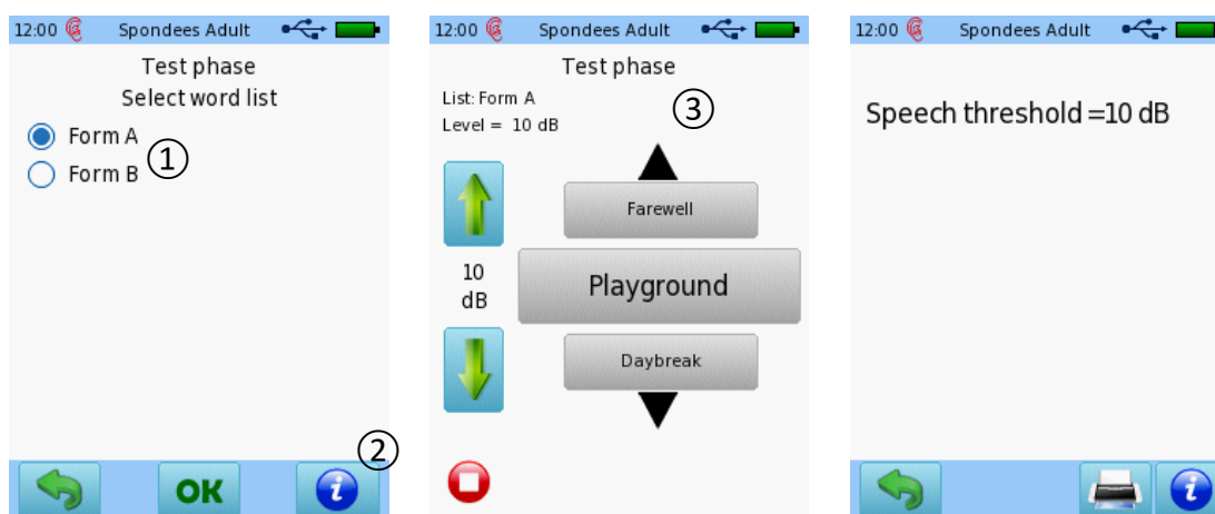
Figure 18: Adaptation de l'interface utilisateur UST pour une détermination simplifiée des seuils vocaux (à gauche : sélection de liste ; au milieu : test avec sélection de l'intensité pour la détermination du seuil vocal ; à droite : vue des résultats)
