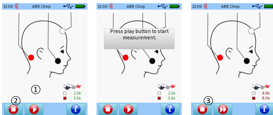
Figure 49: Mesure de l'impédance PEA (à gauche : bonnes impédances avec le bouton play ; au milieu : bonnes impédances avec le bouton play et un rappel pour démarrer le test en appuyant sur le bouton play ; à droite : mauvaises impédances avec le bouton continuer)
