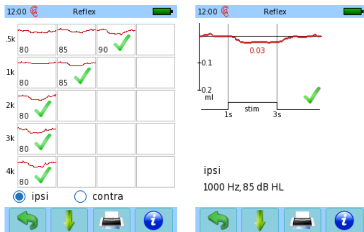
Figure 82: Résultat du réflexe stapédien (à gauche : vue d'ensemble du résultat ; à droite : informations détaillées)
