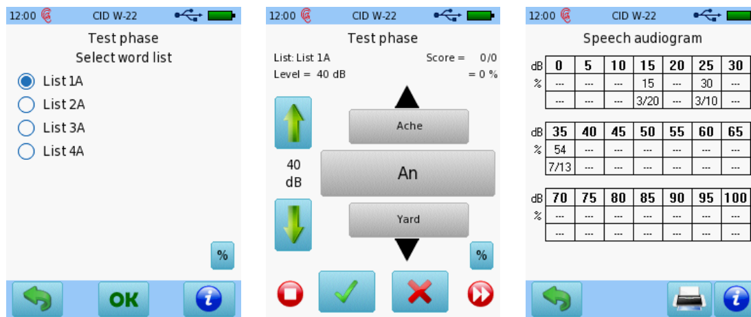
Figure 19: Adaptation de l'interface utilisateur UST pour la détermination des seuils vocaux avec contrôle de l'intensité pendant le test d'une liste unique (à gauche : sélection de la liste ; au milieu : test avec sélection et notation de l'intensité ; à droite : vue du résultat initial sous forme de tableau)
