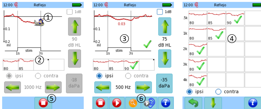
Figura 81: Medición de reflejo acústico automático (izquierda: determinación de umbral con modo historieta activado; centro: modo manual después de terminada la prueba; derecha: visualización general de los resultados en curso)
