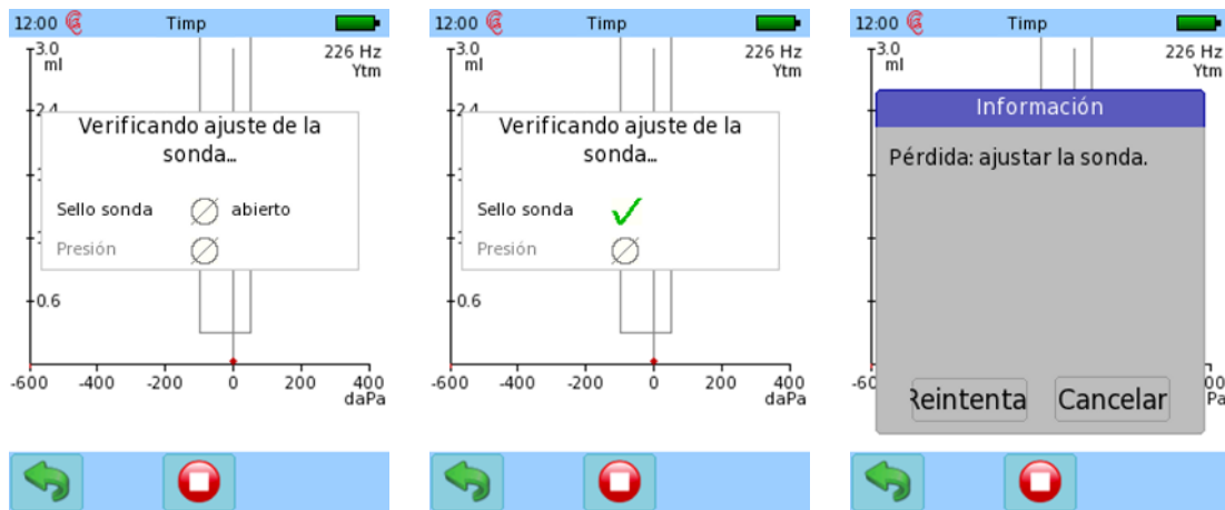
Figura 77: Control de colocación de sonda para timpanometría (izquierda: colocación de sonda no válida al comenzar la prueba; centro: colocación de sonda válida al comenzar la prueba; derecha: colocación de sonda no válida durante la prueba)
